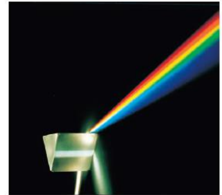
Figure 4.19 Un prisme réfracte la lumière en différentes couleurs, à des angles différents.
